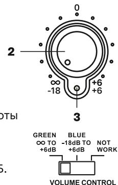
ЗЕЛЁНЫЙ - полный диапазон регулировки от  $\infty$  до +6 дБ. Может использоваться для оперативной регулировки уровня, при контроле монофонического сигнала.
