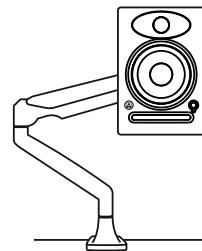
При выборе крепления VESA обращайте внимание на то, что стандарт 100x100 является максимально возможным для крепления к модели SOURCE 5. Не используйте кронштейны, предназначенные в том числе и для большего шага крепления 200, 300 мм и т.д. Максимально возможная площадка для прилегания крепления составляет 130x130 мм. Кронштейны с площадкой большего размера будут пересекаться с выступающими органами настройки монитора.
