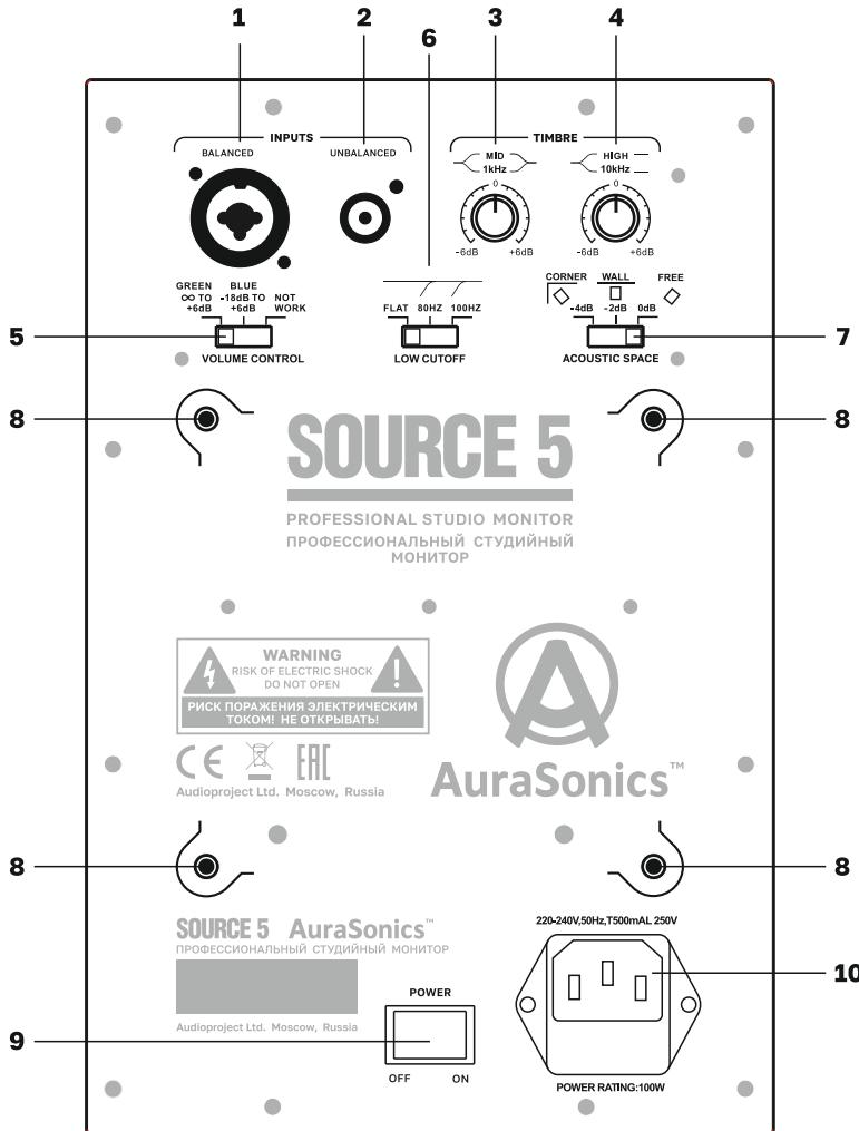
**1 Балансный вход XLR-Combo-Jack.** Используется для балансного подключения\* к профессиональной аппаратуре.
