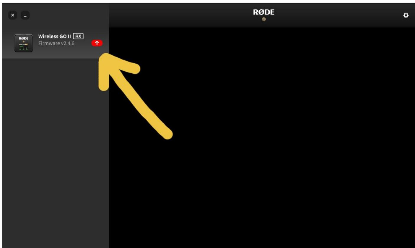
6. Нажмите на красную кнопку с изображением стрелки. Программа определит уровень заряда аккумулятора на устройстве и в случае, если уровень заряда ниже 15% на экране вы увидите такое окно:
